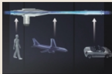
冷媒の速度が極端に変わるエジェクタを独自の数値解析技術と製造技術により実現
